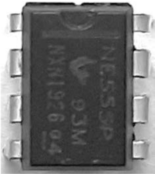
Rysunek w.3. Po ustawieniu układu tak, aby widoczny był napis, a półokrągłe wycięcie znalazło się u góry, w lewym górnym rogu mamy nóżkę o numerze 1, w lewym dolnym rogu — 4, w prawym dolnym rogu — 5, a w prawym górnym rogu — 8
