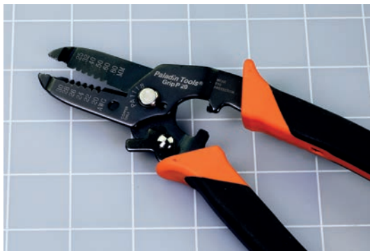
Rysunek 6.6. Szczypce do zdejmowania izolacji z drutu
