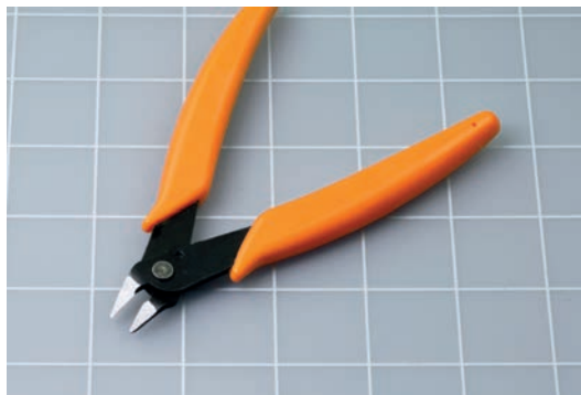
Rysunek 6.4. Cążki pozwalają na pracę tam, gdzie nie sięgną szczypce do cięcia drutu
