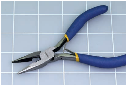
Rysunek 6.2. Długość kombinerek przeznaczonych do pracy z elektroniką nie powinna przekraczać 13 cm
