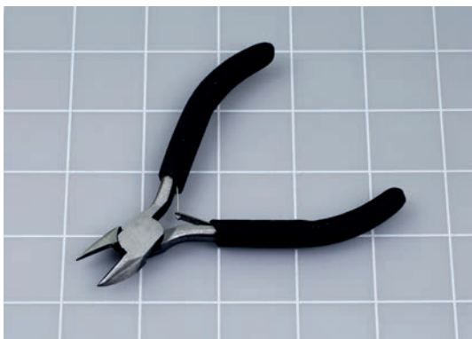
Rysunek 6.3. Długość szczypców do cięcia drutu nie powinny przekraczać 13 cm
