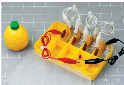
Rysunek 1.60. Sok z cytryny w butelce wydaje się działać równie dobrze co ten wyciśnięty z samego owocu, ale oparta na nim bateria nie będzie wyglądała tak dobrze; tę czteroogniową baterię utworzyłem na bazie pudełka z przegródkami
