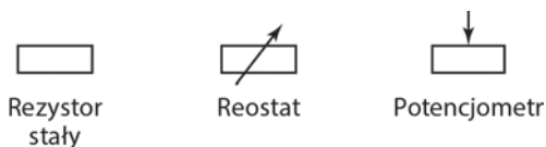
Rysunek 5.8. Symbole do oznaczania rezystorów
