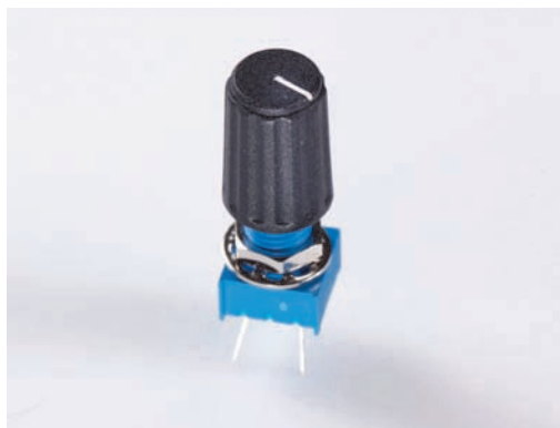
Rysunek 3.10. Potencjometry mogą posłużyć do pomiaru obrotu
