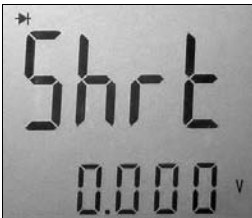
Rysunek 10.16. Sygnalizacja zwarcia obwodu albo zerowego napięcia przewodzenia wskazują na błąd pomiaru lub uszkodzoną diodę świecąca
