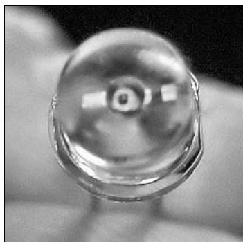
Rysunek 10.9. Widok na odbłyśnik i strukturę półprzewodnikową
