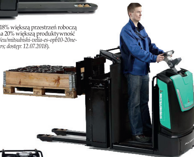
Fot. 4. Wybrane opcje w zakresie widel wznoszących i podestów zwiększają funkcjonalność wózka, umożliwiając dostosowanie go do każdego zastosowania (fot. https://www.a1-mitsubishi.co.uk/en/eu/mitsubishi-velia-es-opb10-20ne-series-low-level-order-pickers ; dostęp: 12.07.2018).
