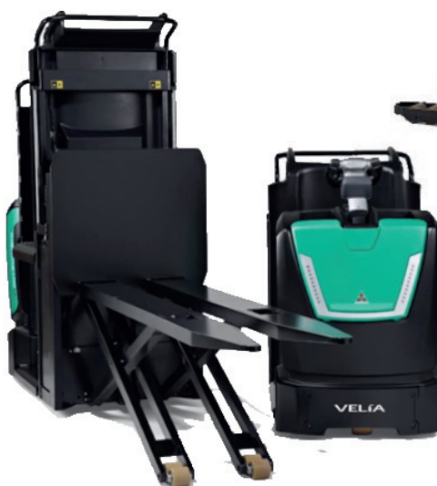
Fot. 5. Niektóre rozwiązania (w tym podnoszony podest i widły) zostały zaprojektowane z myślą o zaspokojeniu najbardziej specyficznych potrzeb, np. w zakresie realizacji zamówień w strefach w połowie wysokości regału.
