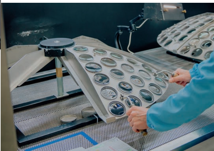
Fot. 5. Nakładanie powłoki antyrefleksyjnej (fot. JZO SA).
