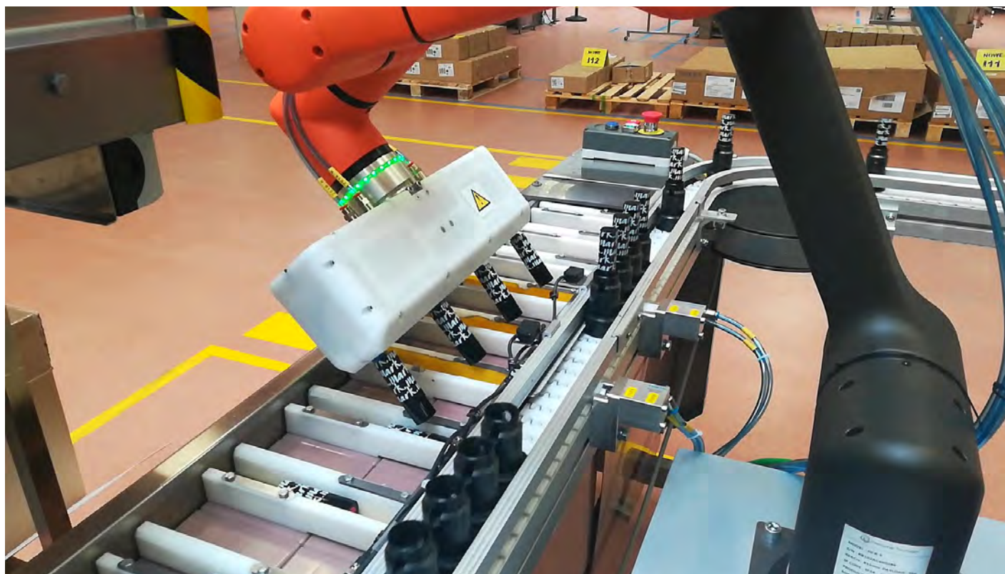
Cobot HCR przy obsłudze linii produkcji kosmetyków
