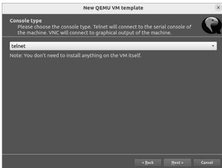
RYSUNEK 1.29. Qemu, sposób nawiązania komunikacji z wirtualną maszyną
