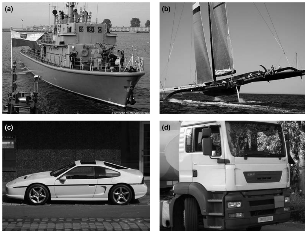
Rys. 1.1. Różne konstrukcje z kompozytów polimerowych: (a) trałowiec Marynarki Wojennej RP, (b) trimaran z kompozytów z włóknem węglowym, (c) Pontiac Fierro z różnego typu kompozytów polimerowych, (d) kabina ciężarówki, (e) wagon kolei ultraszybkiej, (f) lekki samolot, (g) szybowiec, (h) Boeing 787 „Dreamliner”, w którym kompozyty stanowią 50% masy konstrukcji, (i) rakietka tenisowa, (j) rotory elektrowni wiatrowych, (k) kopuła radarowa z laminatowych trójkątów sferycznych, (l) zbiorniki nawijane
