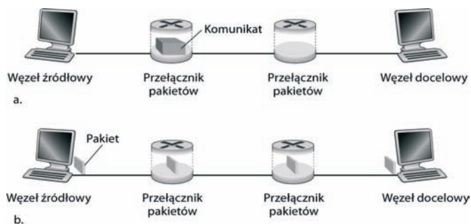
RYСУNEK 1.21. Transport komunikatu między węzłami: (a) — bez zastosowania segmentacji; (b) — z wykorzystaniem segmentacji
