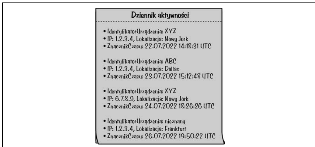
Rysunek 6.4. Dziennik aktywności urządzeń, wykorzystywany do audytowania, wykrywania nietypowych zachowań i wyliczania oceny zaufania
