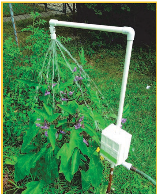
RYСУNEK 2.21. Robot podlewający rośliny zgodnie z zaprogramowanym harmonogramem
