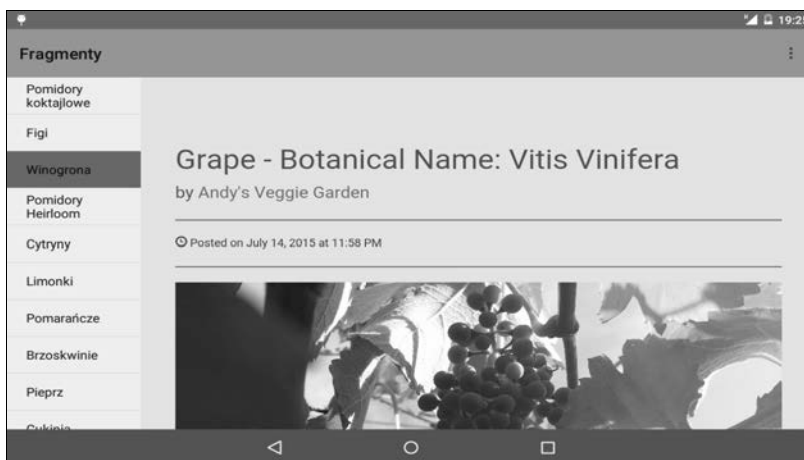
Rysunek 9.4. W układzie poziomym oba fragmenty są widoczne na ekranie jednocześnie i działają w ramach jednej aktywności
