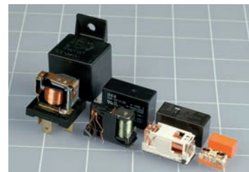
Rysunek 2.57. Cztery przełączniki różnego typu zasilane napięciem 12 V, pokazane w swojej obudowie i bez niej. Przełącznik stosowany w samochodach (skrajnie lewy) jest najprostszy i najłatwiejszy do zrozumienia, ponieważ przy jego projektowaniu rozmiar obudowy nie miał szczególnego znaczenia. Mniejsze przełączniki są zaprojektowane bardziej pomysłowo, ich konstrukcja jest bardziej złożona i trudniejsza do rozpracowania. Mniejsze przełączniki są przeważnie przeznaczone do przłączania mniejszych prądów niż ich większe odpowiedniki
