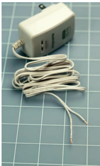
Rysunek 2.50. Po drugie, odizoluj przewody w taki sposób, aby jeden z nich był krótszy od drugiego. Zmniejsz w ten sposób ryzyko ich wzajemnego zetknięcia. Pokoloruj przewód z wyższym potencjałem, używając markera, lub doklej do niego etykietkę
