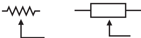
Rysunek 2.42. Symbole potencjometrów: po lewej stronie wersja używana w Stanach Zjednoczonych, po prawej wersja europejska. W obu przypadkach strzałka symbolizuje ruchomy element dotykający rezystancji (najczęściej podłączony do środkowego wyprowadzenia)
