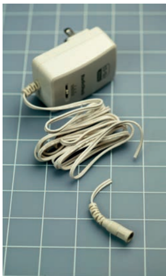
Rysunek 2.49. Przygotowanie zasilacza uniwersalnego. Zacznij od odcięcia wtyczki dostarczającej niskie napięcie i wyrzuć ją do kosza
