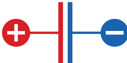
Rysunek 2.67. Kiedy do kondensatora przyłożone zostanie stałe napięcie, nie płynie żaden prąd, ale on sam ładuje się tak jak bateria. Dodatni i ujemny ładunek są jednakowe, ale przeciwstawne wobec siebie
