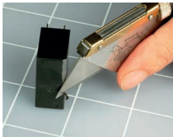
Rysunek 2.52. Aby zajrzeć do zabezpieczonego przełącznika, przycinaj krawędzie przełącznika do momentu, kiedy uzyskasz minimalną wolną przestrzeń
