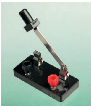
Rysunek 2.25. Jednobiegunowy, jednopozycyjny przełącznik tworzy wyłącznie jedno połączenie. Jego dwoma stanami są: stan włączony i wyłączony
