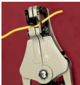
Rysunek 2.19. Kiedy ściśniesz ręczki narzędzia do automatycznego zdejmowania izolacji, szczęki po lewej stronie chwyć przewód, a ostre rowki po prawej wbijają się w izolację. Kiedy ściśniesz mocniej, obie szczęki oddalają się od siebie, zdejmując izolację z przewodu
